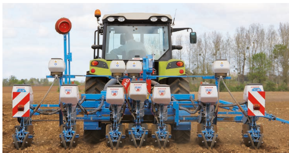
La version Extend mixte 6/7 rangs offre des écartements de 75 et 80 cm en 6 rangs et de 55 et 60 cm en 7 rangs. Il est ainsi possible de passer très rapidement et sans démontage d'un 6 rangs Mais à un 7 rangs Tournesol/Colza.
