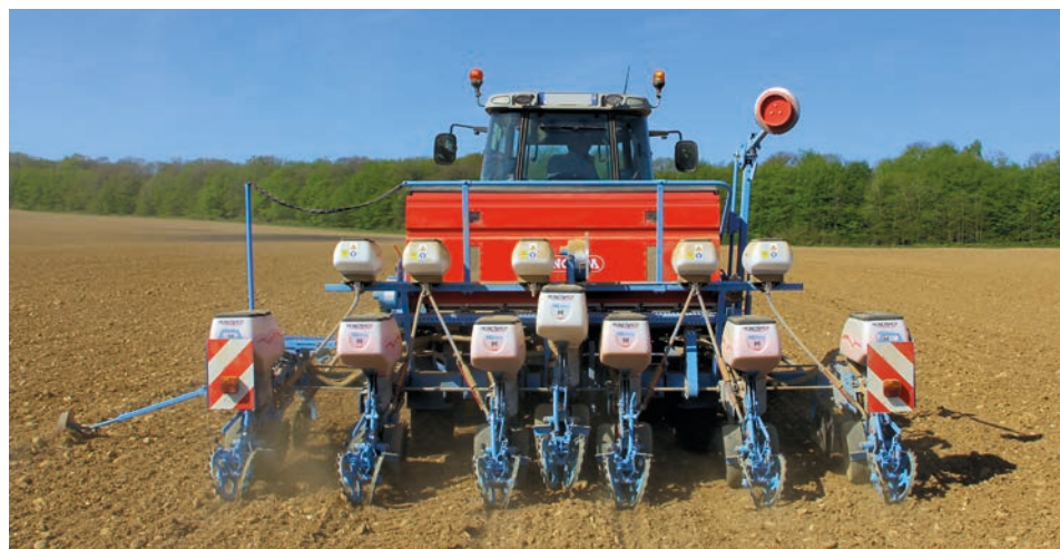
La version Monobloc2 Mixte 6/7 rangs offre des écartements de 75 ou 80 cm en 6 rangs et de 56,2 ou 60 cm en 7 rangs. La fertilisation en 6 et 7 rangs est possible.
