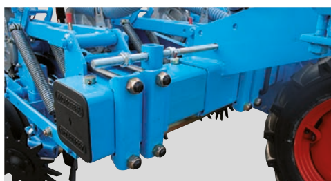
Des butées sur le système de télescopage permettent un réglage parfaitement adapté à l'inter-rang souhaité et un repliage adapté aux équipements.
