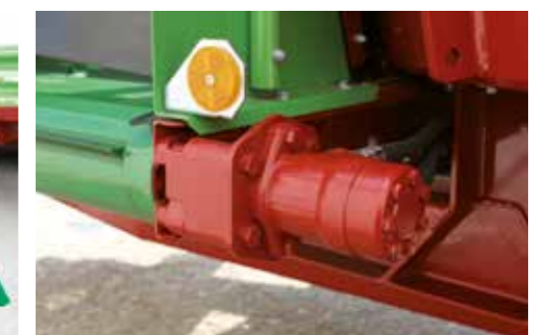
Moteurs hydrauliques : vitesse du moteur au choix selon l'application
