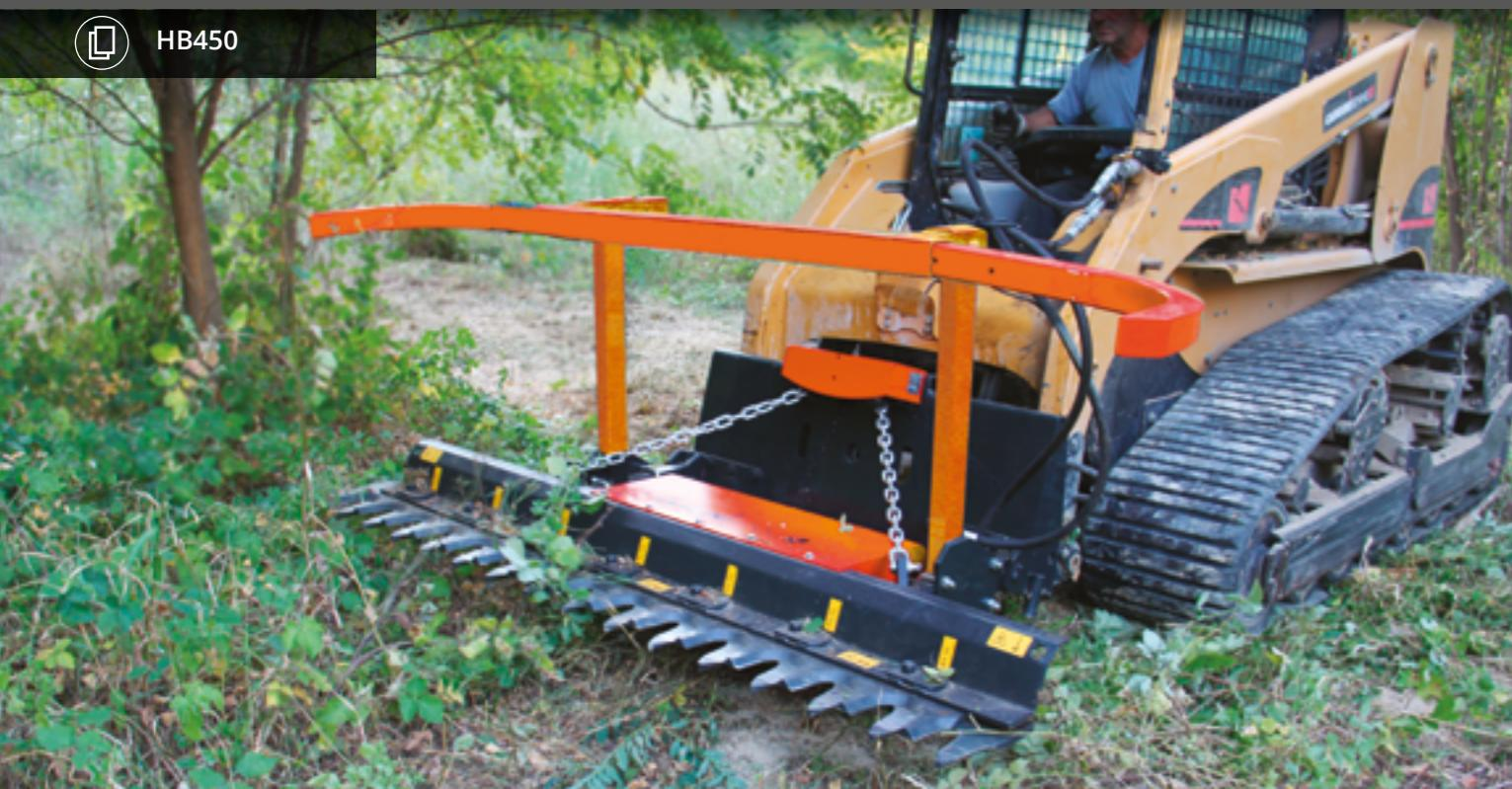
CETTE BARRE SHARP-CUT D'ÉLAGAGE EST ADAPTÉE À LA TAILLE DE BRANCHES JUSQU'À 100 MM. ELLE N'ABIME PAS LA PLANTE EN EXÉCUTANT UNE TAILLE NETTE ET PRÉCISE QUI NE DÉCHIRE PAS LA BRANCHE. SES LAMES SONT EN HB450, CE QUI ASSURE RÉSISTANCE ET DURETÉ DANS LE TEMPS.
