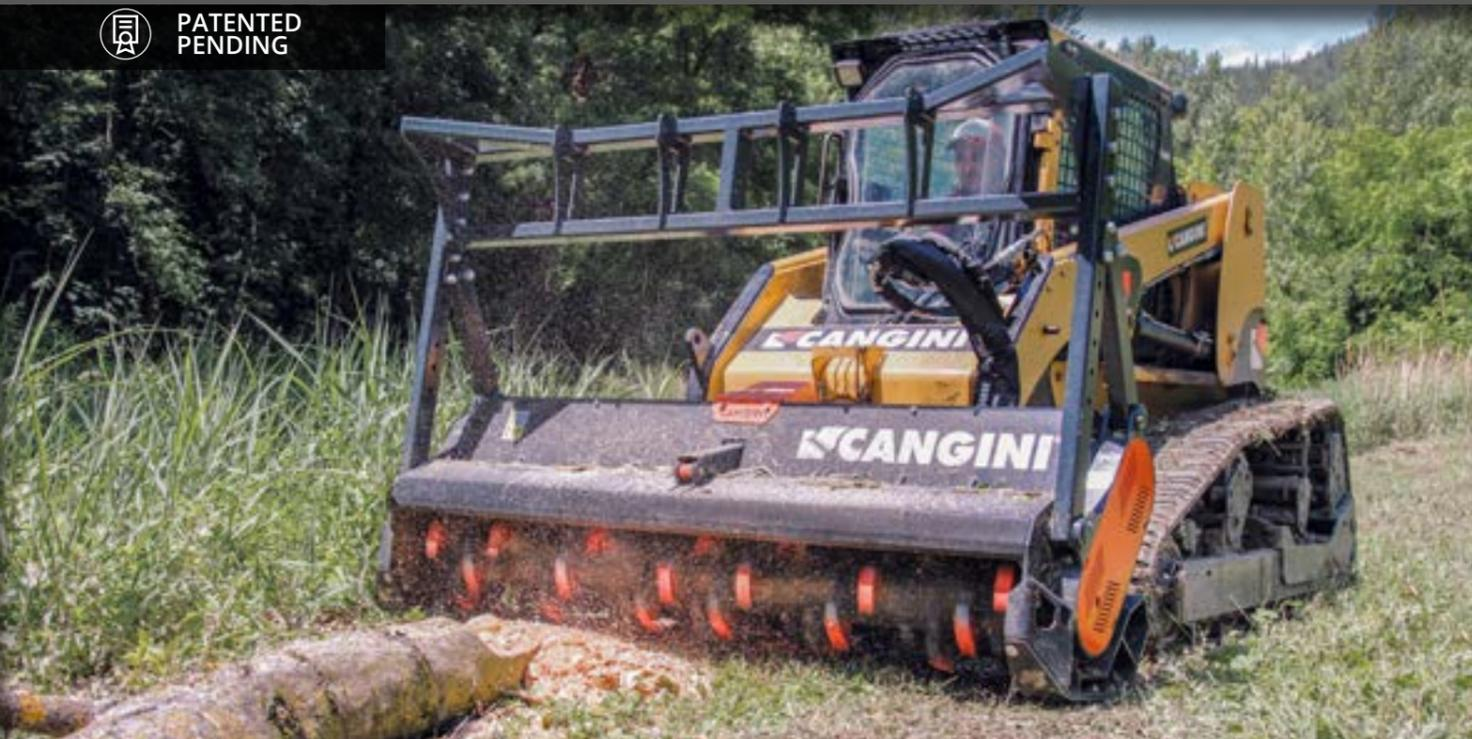
POUR LA VERSION FRONTALE, MÊME RÉSIDENCE, GRÂCE AU CORPS RENFORCÉ, LE GROUPE DE SOUPAPES INTÉGRÉ DE SÉRIE, PROTÈGE LE MOTEUR À PISTONS DES PICS DE PRESSION. C'EST L'OUTIL IDÉAL POUR FAIRE DES BANDES COUPE-FEU, OUVRIR DES PISTES, DES CHEMINS ET COUPER DES PLANTES.
