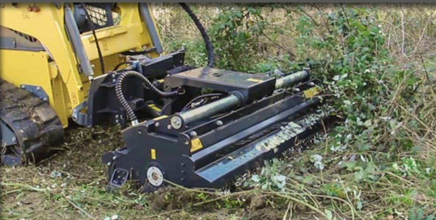
LE BROYEUR FRONTAL TC PRÉSENTE UNE DOUBLE COQUE QUI DONNE UNE RÉSISTANCE PLUS ÉLEVÉE AUX CHOCS. DOTÉ DE CHÂSSIS COULISSANT MÉCANIQUE DE SÉRIE (OU HYDRAULIQUE OPTIONNEL), DE SYSTÈME FLOTTANT VERTICAL ET D'UNE ADAPTATION AU PLAN HORIZONTAL DE  $\pm 10^\circ$ . L'ÉPAREUSE EST DOTÉE AUSSI DE VANNES BYPASS ET RÉGULATRICES DE FLUX ET DE PRESSION, OUTRE QUE DE COUTEAUX EN Y AVEC LAME INTERMÉDIAIRE OU MARTEAUX DE SÉRIE.
