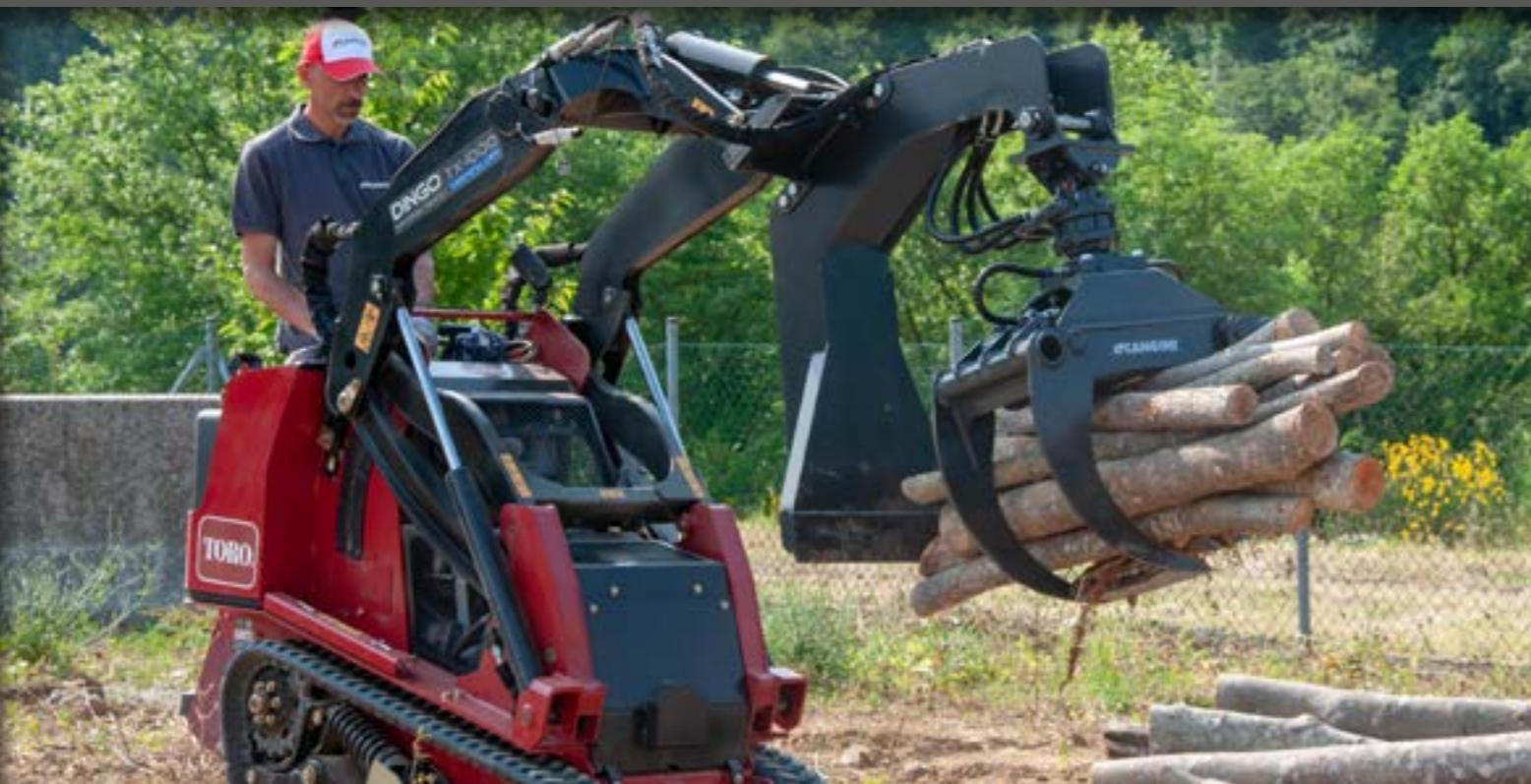
LA PINCE À BOIS SE CARACTÉRISE PAR UNE ROTATION À 360 ° AVEC UN ROTATEUR HYDRAULIQUE À BRIDE. LES PIÈCES LES PLUS SUJETTES À USURE SONT EN DOMEX 700. EN STANDARD, IL EST ÉQUIPÉ D'UNE VANNE DE BLOCCAGE SUR LE CYLINDRE DE FERMETURE.
