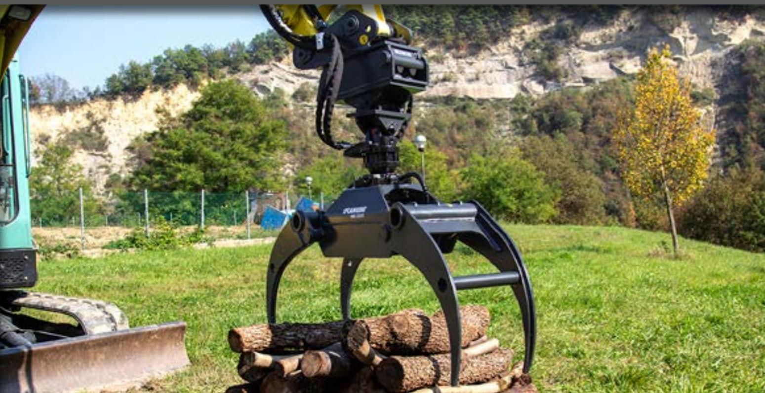
ROTATION À 360°, FONCTION GARANTIE PAR LES ROTATEURS HYDRAULIQUES DONT ELLE PEUT ÊTRE ÉQUIPÉE, FACILITE ALORS CONSIDÉRABLEMENT LA SAISIE DU MATERIAU COUPÉ PAR L'OPÉRATEUR, PIÈCES D'USURE EN DOMEX 700. ELLE EST PARTICULIÈREMENT ADAPTÉE À LA MANIPULATION DE BOIS COUPÉ ET BRANCHAGES. ELLE EST DOTÉE DE SÉRIE DE VALVE DE BLOCAGE SUR LE VÉRIN DE FERMETURE. VALVE DE BLOCAGE FOURNIE STANDARD ET MONTÉE SUR LE VÉRIN DE FERMETURE.
