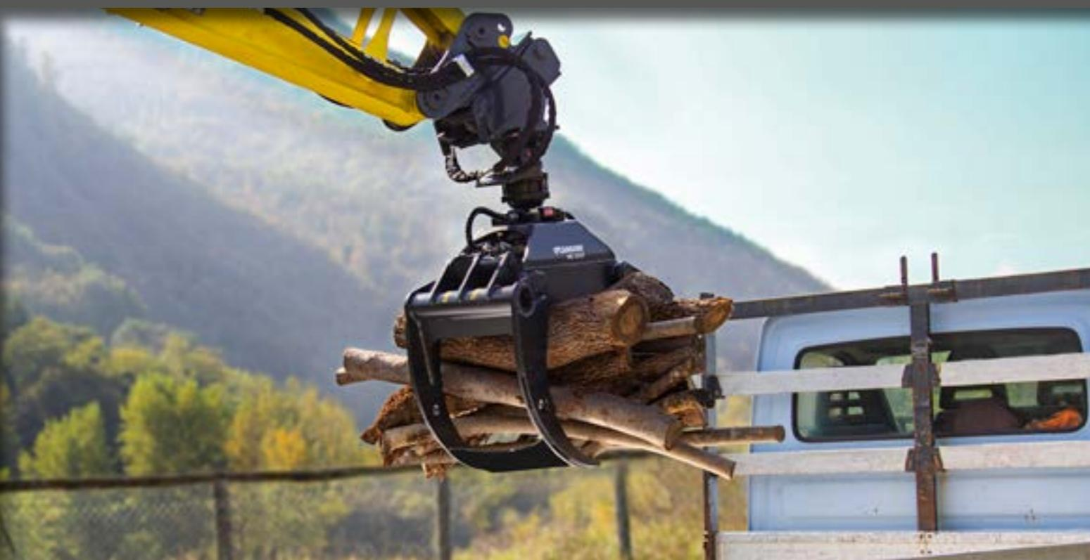
LA PINCE À BOIS PEUT ÊTRE ÉQUIPÉE D'UNE ROTATION HYDRAULIQUE À 360 °, LES PIÈCES D'USURE SONT EN DOMEX 700. DE SÉRIE, ELLE EST ÉQUIPÉE D'UNE VANNE DE BLOCCAGE SUR LE CYLINDRE DE FERMETURE.
