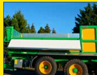
Hydraulisch einklappbare Seitenwände
