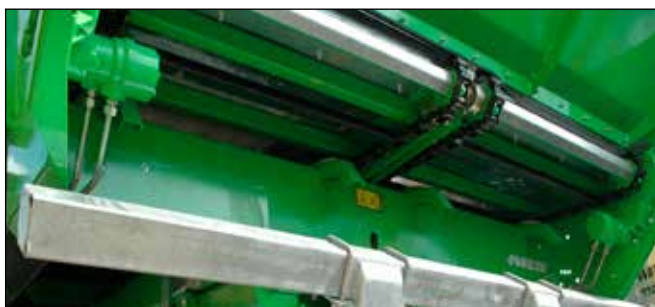
Aandrijving van de bodemketting door twee hydraulische motoren
