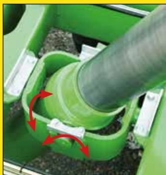
Cadre à double oscillation dans lequel est placé le vérin
