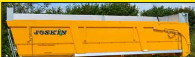
Combinaison de rehausSES en alu et d'une rehausse hydraulique en acier (50 cm)
