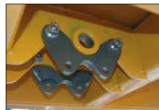
Ancrage du vérin
