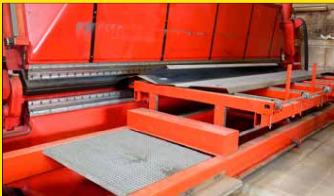
Pliuse à commande numérique d'une force de pression de 600 tonnes
