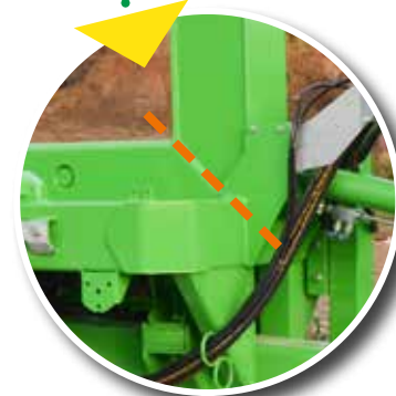
Bauweise des Teleskoparms mit diagonaler Verschweißung und Verstärkung, welches ihn viel fester macht.
