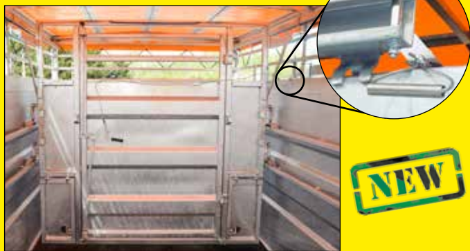
Binnendeur uitgerust met een hendel om veilig van buiten te open
