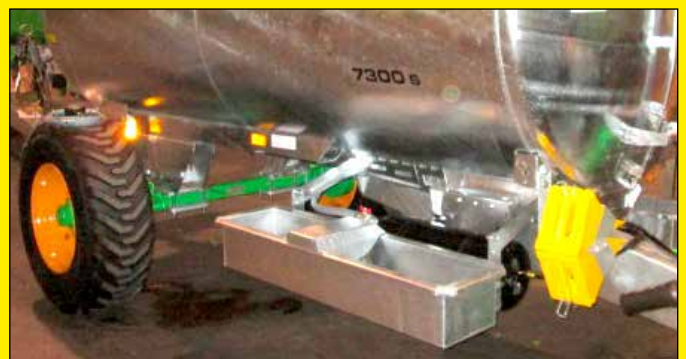
Drinkbak met constant niveau aan de zijde
