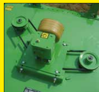
La transmission est assurée par 2 courroies trapézoïdales qui entraînent les différents rotors d'entretien.
