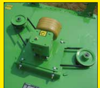
Die Rotoren werden durch zwei Keilriemen angetrieben.
