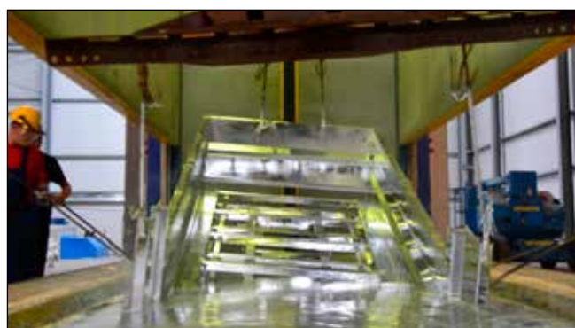
Bain de galvanisation à chaud (intérieur et extérieur)
