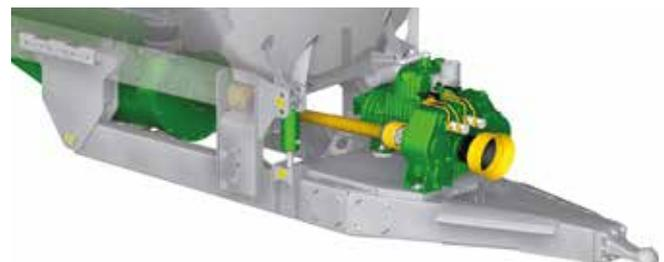
Mechanischer Antrieb über das Getriebe der 2 Pumpen
