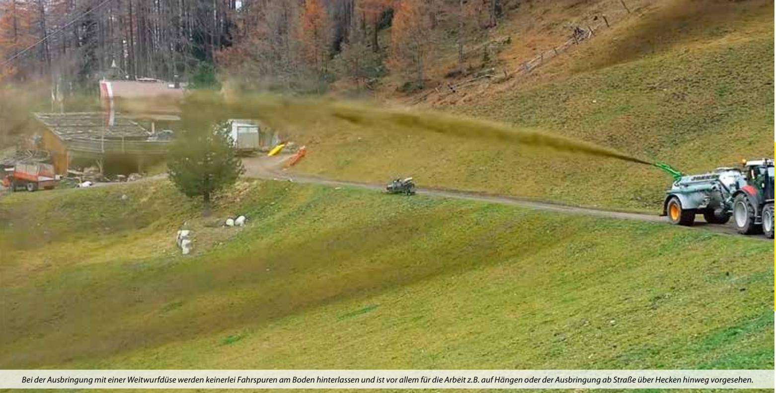
Bei der Ausbringung mit einer Weitwurfdüse werden keinerlei Fahrspuren am Boden hinterlassen und ist vor allem für die Arbeit z.B. auf Hängen oder der Ausbringung ab Straße über Hecken hinweg vorgesehen.
