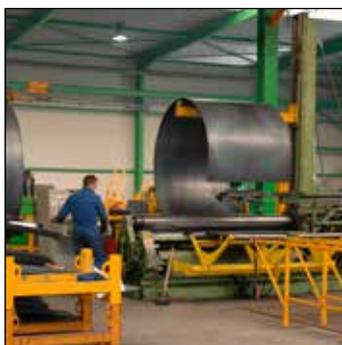
*Biegen des Bleches (digital gesteuerte Biegepresse)*
