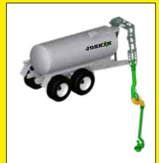
Vorderer Ansaugrüssel mit eingetauchtem Turbofüller
