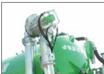
Turbofüller auf gelenkigem seitlichem Ansaugarm
