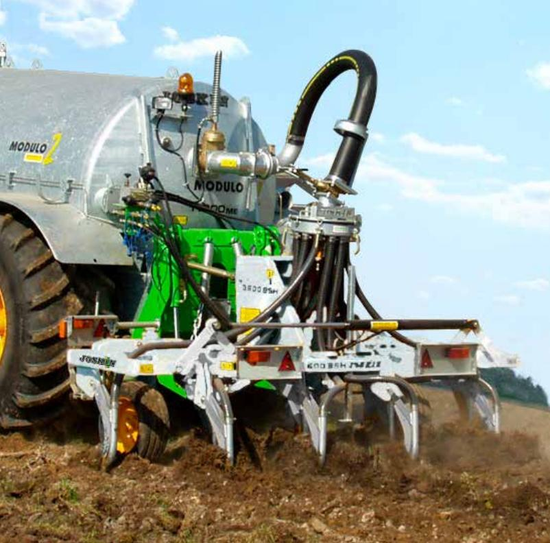
Der Ackerinjektor TERRASOC ist mit 40 cm voneinander getrennten starren Zinken versehen, die flache Gänsefußschare tragen (24 cm Breite) mit Scherbolzensicherung. Angesichts der Form der Zinken und der breiten Aussparung der Schare entsteht ein guter Durchfluss der Gülle. Die Vorteile dieses Systems liegen in:
