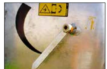
Füllstandsanzeiger mit Schwimmer
