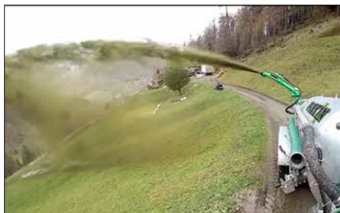
Senkrechte Ausrichtung der Weitwurfdüse durch Hydraulikzylinder (optional).
