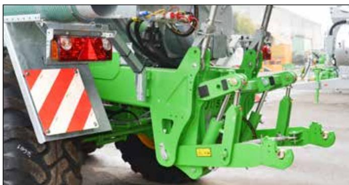
*Das integrierte Lift-Hubwerk (völlig im Fahrgestell integriertes Hubwerk) auf QUADRA, X-TREM, TETRAX, VOLUMETRA und EUROLINER*
