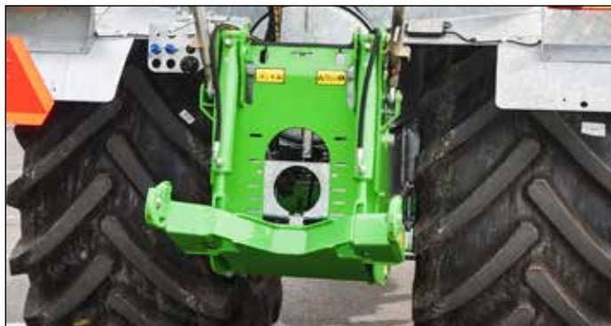
*Das schmale Hubwerk auf COBRA (durch 4 konische Bolzen befestigt, für mehr Robustheit)*
