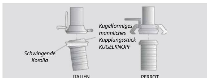
JOSKIN verwendet 2 verschiedene Kupplungen "Italien" und "Perrot" (Standard). Der erste ist relativ leicht aber dank seines gewölbten Kopfes kann er perfekt angepasst werden. Die Perrot-Kupplung ist robust aber erfordert, dass die 2 Teile, die anzuschließen sind, ungefähr in gerader Linie stehen.
