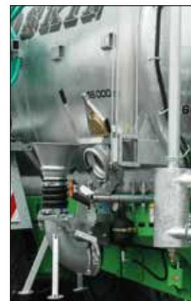
Stütze am Fahrgestell montiert
