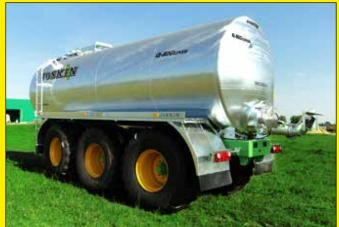
Die Q-BIGLINER Behälter, wie alle Behälter der JOSKIN-Güllefässer, werden nach der Sicherheitsnorm EN707 gebaut. Diese sind mit Schwallwänden versehen, die für die Reduzierung der Flüssigkeitsbewegungen im Fass sorgen.
