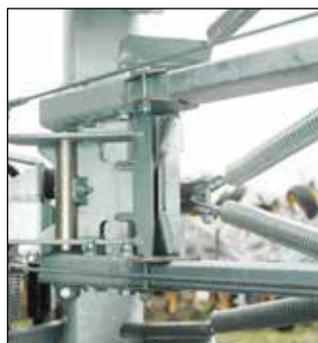
Wenn der Injektor eingeklappt wird, werden die auf den oberen Armen gelegenen Elemente durch ein Verriegelungssystem in Position gehalten. Mit einer einfachen Einkerbung wird eine Rotation der Elemente sowie deren Herunterfallen verhindert. Somit bleiben die Elemente sehr starr angesichts der beim Transport auftauchenden Vibrationen.
