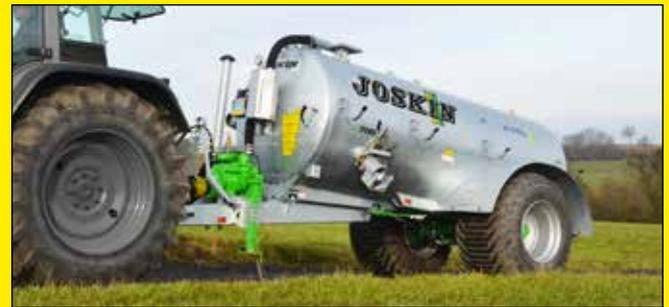
Die Modelle 7000 S und 8000 S werden serienmäßig mit Radkasteneinbau hergestellt. Es ist also durchaus möglich, 800 mm-breite und 1.500 mm große Reifen zu montieren, ohne dass die Gesamtbreite von 2.55 m überschritten wird. Der Radkasteneinbau ist größer als das Rad, damit die Achse bewegt und die Last optimal verteilt werden kann.
