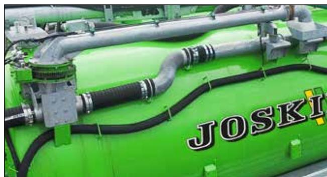
Eine weitere Alternative zum Gülletransfer ist der 8" Arm, mit dem das Transportfass einen Zwischencontainer oder ein Güllefass über die obere Öffnung befüllen kann.
