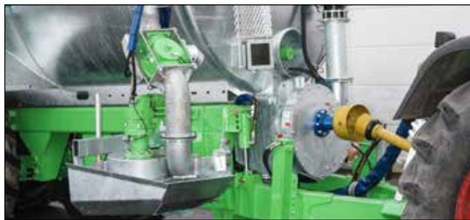
DUAL-STORM mit mechanischem Antrieb der Verdrängungspumpe
