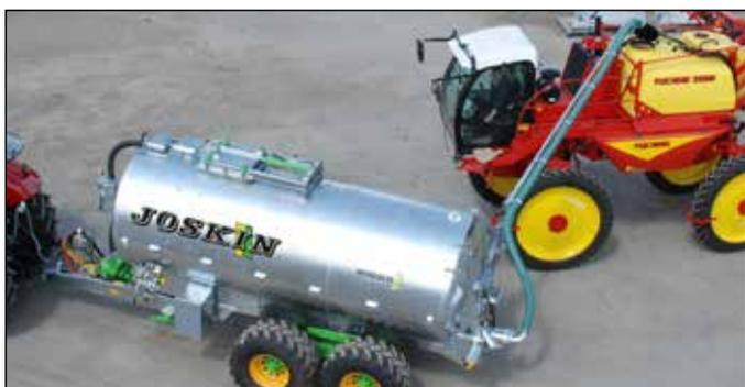
Diese Befüllungs- und Entladungsvorrichtung sind nur für die Güllefässer MODULO2 von 10.000 bis 18.000 Litern verfügbar.
