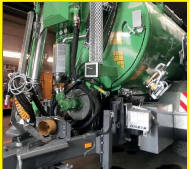
STORM avec entraînement hydraulique Power-Pack
