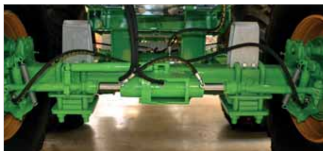
Essieu suiveur (50 % directionnel)
