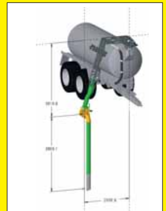
Flèche dorsale en position dépliée montée sur point de pivot à l'avant (les valeurs varient selon la configuration choisie)
