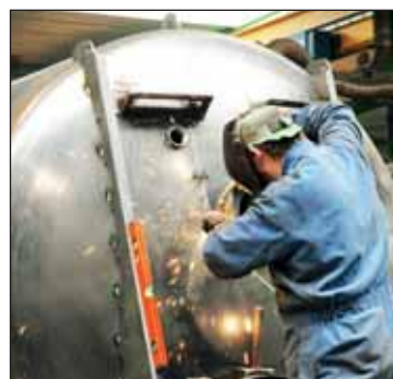
Soudure manuelle des accessoires
