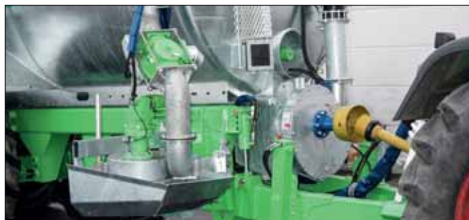
DUAL-STORM avec entraînement mécanique de la pompe de refoulement
