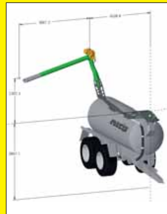
Flèche dorsale en position dépliée montée sur point de pivot à l'avant (les valeurs varient selon la configuration choisie)
