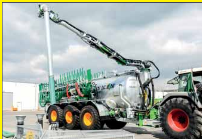
Rugzuigarm met draaipunt boven vooraan op de tank
