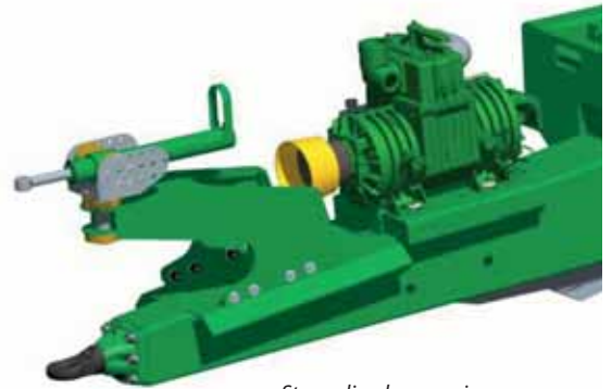
Steun die de spanningen over een groot deel van de dissel verdeelt
