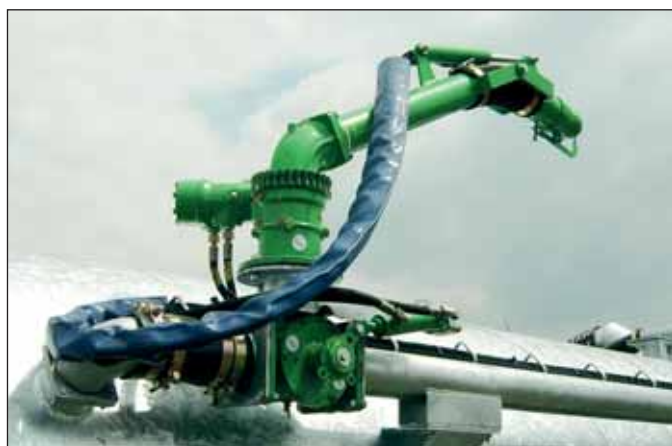
Volumetrisch mengen met retourleiding in de tank via hydraulische driewegkraan
