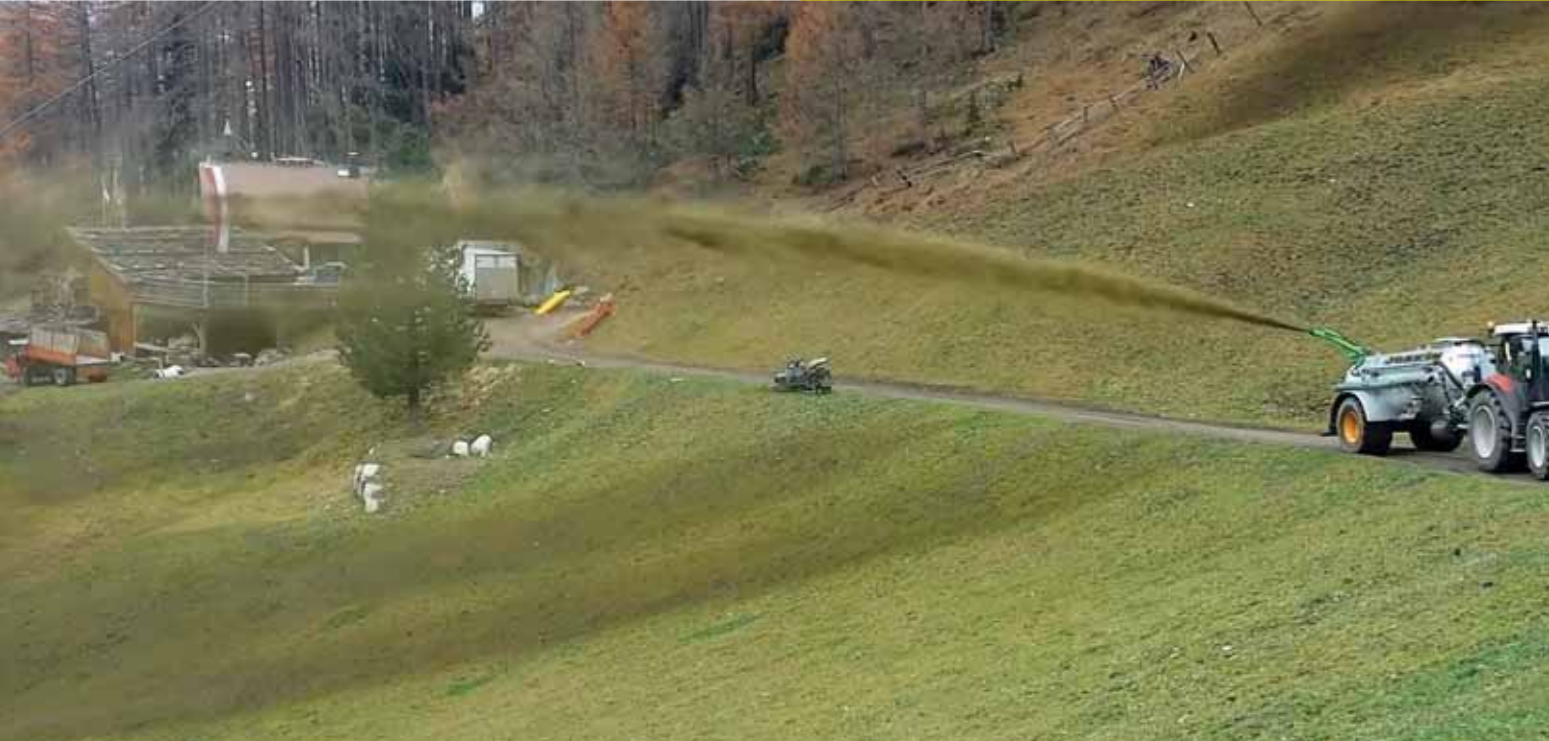
De verspreiding door een kanon voorkomt rijsporen op de bebouwde grond door de straal naar de heuvels te sturen, zelfs boven hagen vanop de weg.
