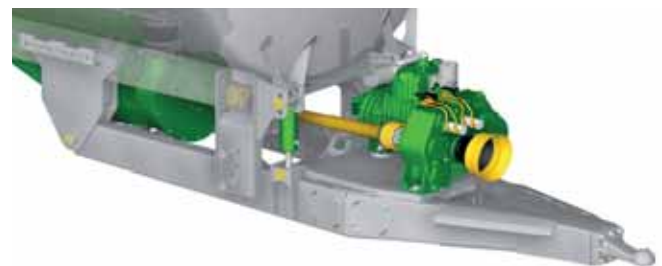
Mechanische aandrijving door aftakas van de pompen
