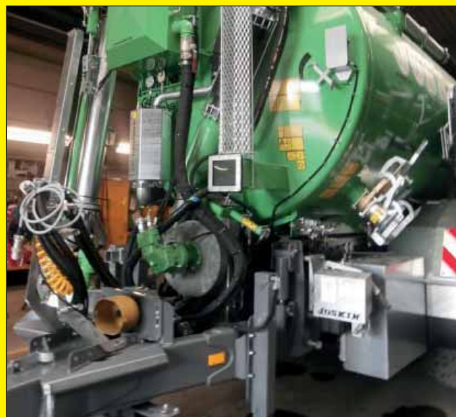
STORM met Power-Pack hydraulische aandrijving
