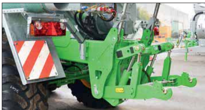
Geïntegreerde L hefinrichting (hefinrichting volledig geïntegreerd in het chassis) op QUADRA, X-TREM, VOLUMETRA, TETRAX en EUROLINER
