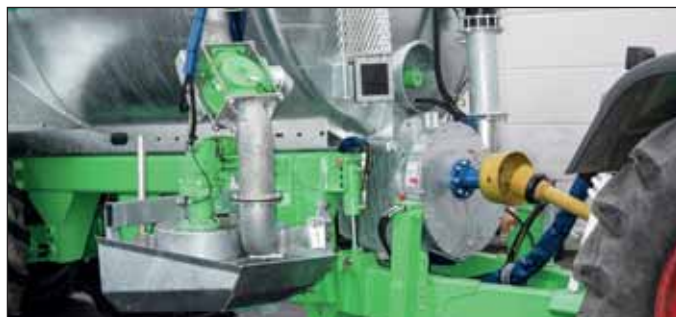
DUAL-STORM met mechanische aandrijving van de leehblazen pomp
