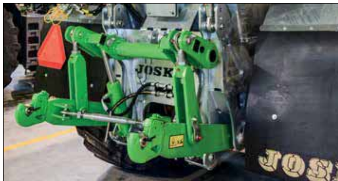
Geïntegreerde L hefinrichting in de tank op VOLUMETRA
