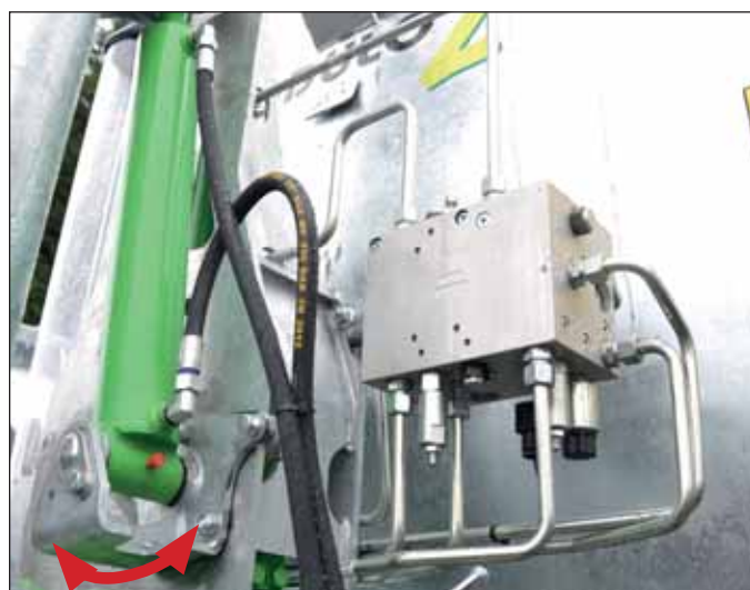
Om van zijde te veranderen, moet enkel de cilinderbasis verplaatst worden naar rechts of links.
