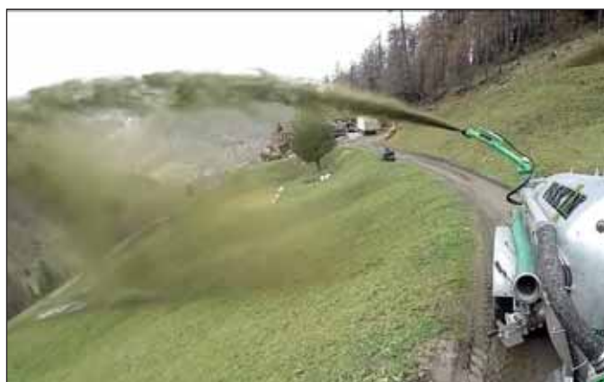
De verticale oriëntatie van het verspreidingskanon door een hydraulische cilinder (optioneel)
