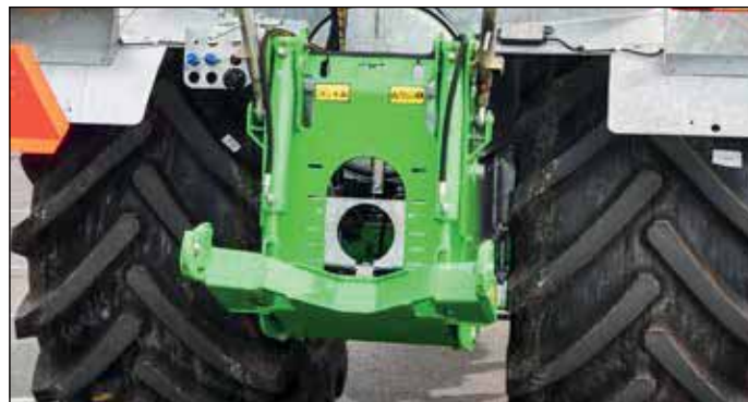
L600 hefinrichting op COBRA (bevestigd door 4 conische assen om een stevig geheel ervan te maken)
