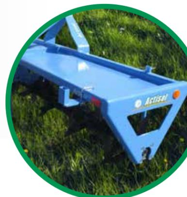
Positionnés hélicoïdalement sur un axe transversal, les couteaux répartis en quinconce sur des entretoises distantes de 18 cm (12 points au m<sup>2</sup>) perforent le sol et assurent une scarification rhizosphérale.
