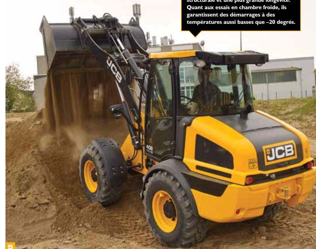
L'analyse par élément fini et les essais au banc assurent une meilleure résistance structurale et une plus grande longévité. Quant aux essais en chambre froide, ils garantissent des démarrages à des températures aussi basses que -20 degrés.
